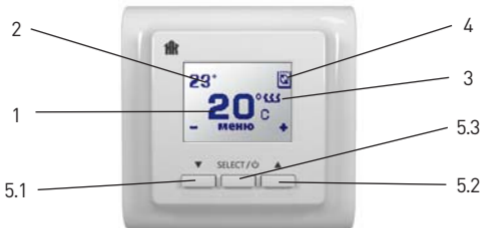
Рис. 2 Главная индикация в основном режиме работы
